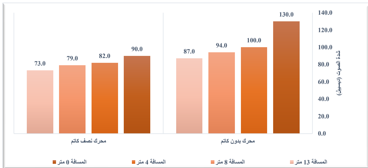
شكل (5): شدة الصوت (ديسيبل) بين محرك كهربائي بدون كاتم وآخر نصف كاتم (250 كيلووات) عند مسافات مختلفة
