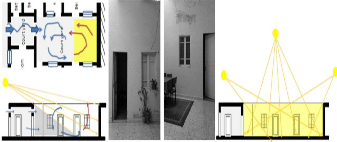
شكل (12): توضيح آلية التهوية والإنارة في المسكن التقليدي عبر الفناء الداخلي، ويظهر تفاعل الفتحات مع حركة الهواء والضوء الطبيعي. تضم الصورة صوراً واقعية للفناء وأبعاده المناخية. المصدر: (ساسي، 2018).
